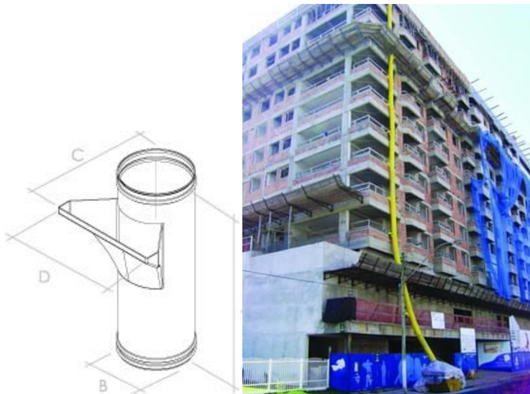
Figura 6 – Desenho esquemático de tubo de queda (A) e duto de queda para disposição dos ROH (B).
